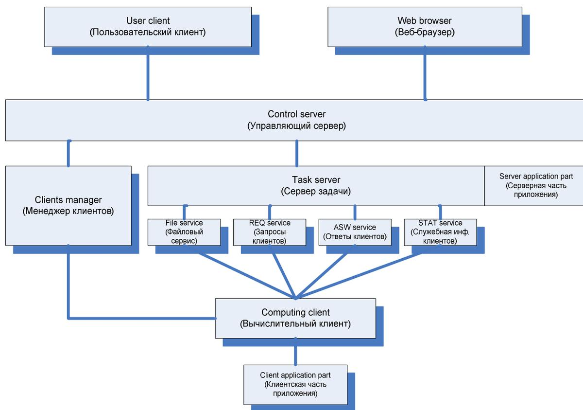
Рис. 1. Архитектура системы X-Com<sup>2</sup>
